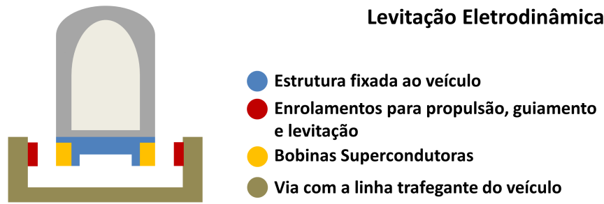
Figura 2.5: Modelo de trem de Levitação Eletrodinâmica.
