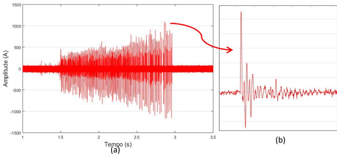
Figura 4.10 - Manobra de fechamento da chave seccionadora Fase B – (a) Sinal completo e (b) Detalhe de um impulso em 2,85 s com pico de 1100A
