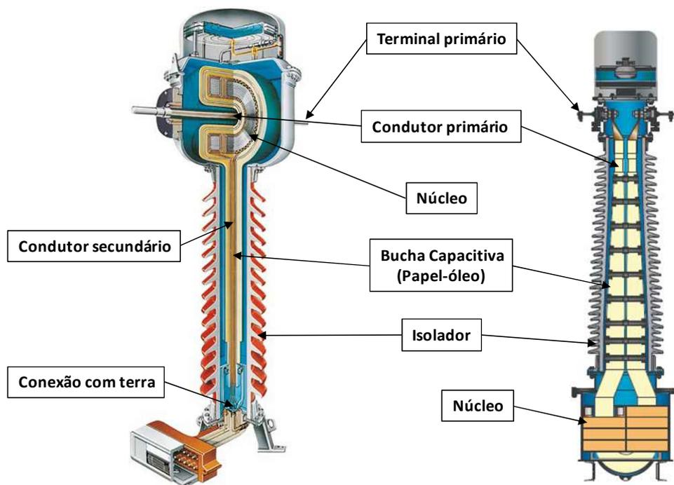
Figura 2.2 - Diferenças entre o tipo Top Core (esquerda) e o Tipo Hair-pin (direita)
