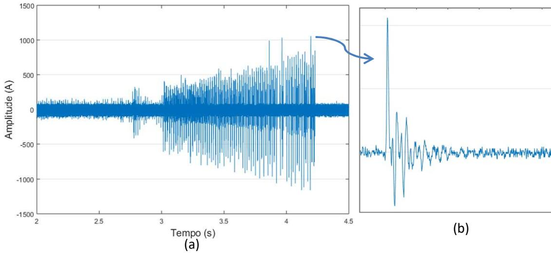
Figura 4.9 - Manobra de fechamento da chave seccionadora Fase A – (a) Sinal completo e (b) Detalhe de um impulso em 4,2 s com pico de 1100A
