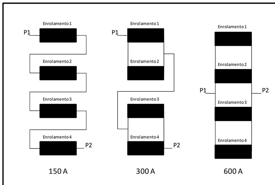
*Figura 2.1 - Exemplo de ligação das bobinas de um TC<sup>[5]</sup>*
