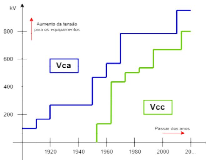
Figura 3.1 - Evolução dos níveis de tensão em sistemas de potência<sup>[16]</sup>
