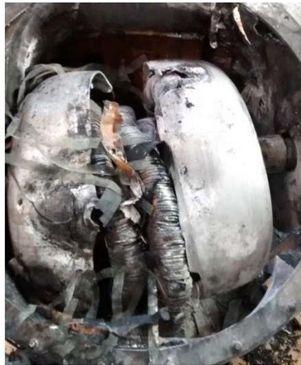
*Figura 2.6 - Exemplo do efeito de uma falha interna em um TC de alta tensão
