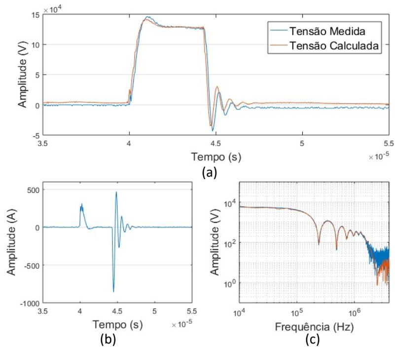
Figura 3.15 – Impulso atmosférico com corte na cauda medido pelo sistema com HFCT: (a) sinal de tensão medido e calculado, (b) sinal de corrente medida e (c) sinal da tensão e calculada no domínio da frequência
