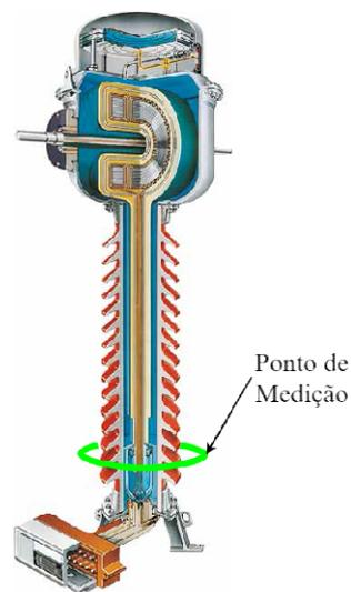
*Figura 3.10 - Instalação da Cinta Capacitiva no TC*
