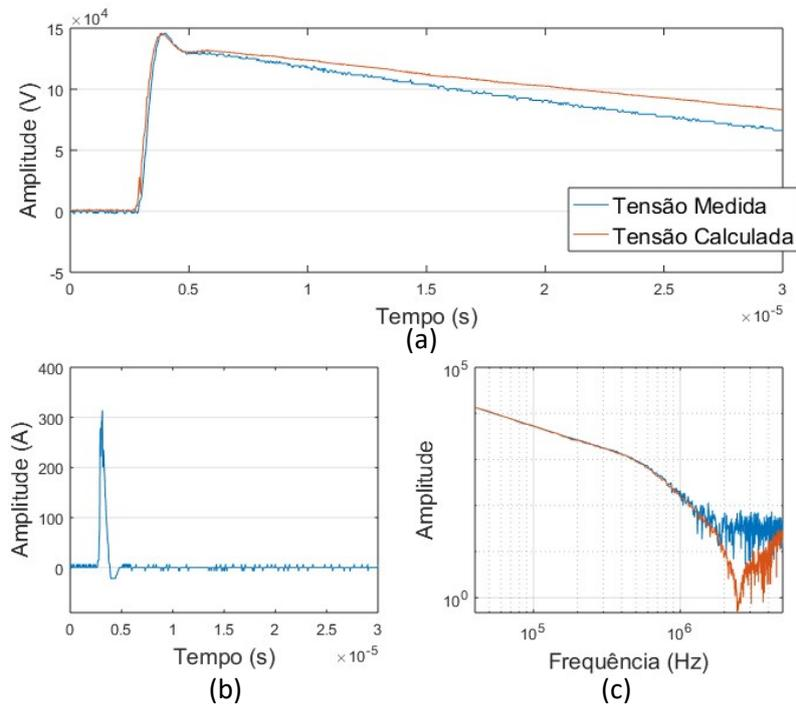
Figura 3.14 - Impulso atmosférico pleno medido pelo sistema com HFCT: (a) sinal de tensão medido e calculado, (b) sinal de corrente medida e (c) sinal da tensão medida e calculada no domínio da frequência
