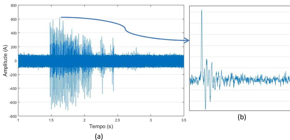
Figura 4.5 - Medição 01 - Manobra de fechamento da chave seccionadora Fase A – (a) Sinal completo e (b) Detalhe de um impulso em 1,6 s com pico de 600 A
