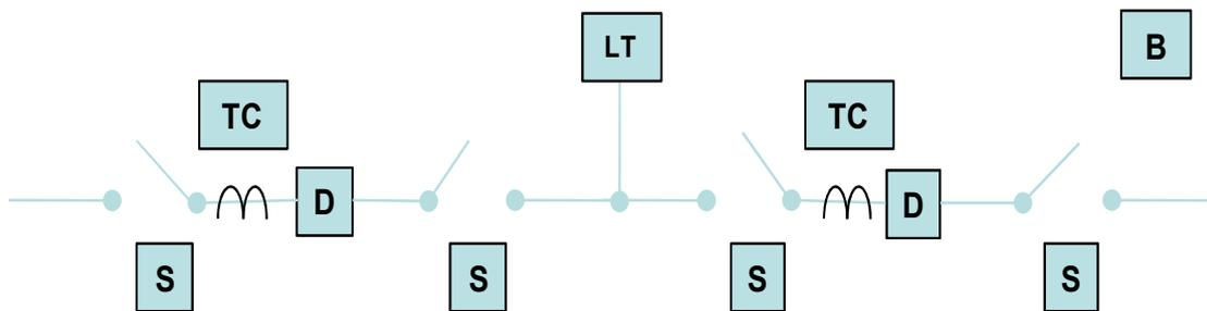
*Figura 4.2 – Arranjo disjuntor e meio simplificado*
