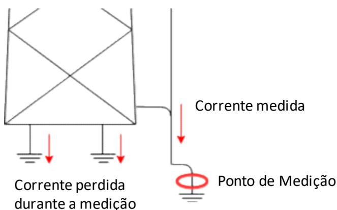
*Figura 4.20 - Divisão da corrente durante a medição*
