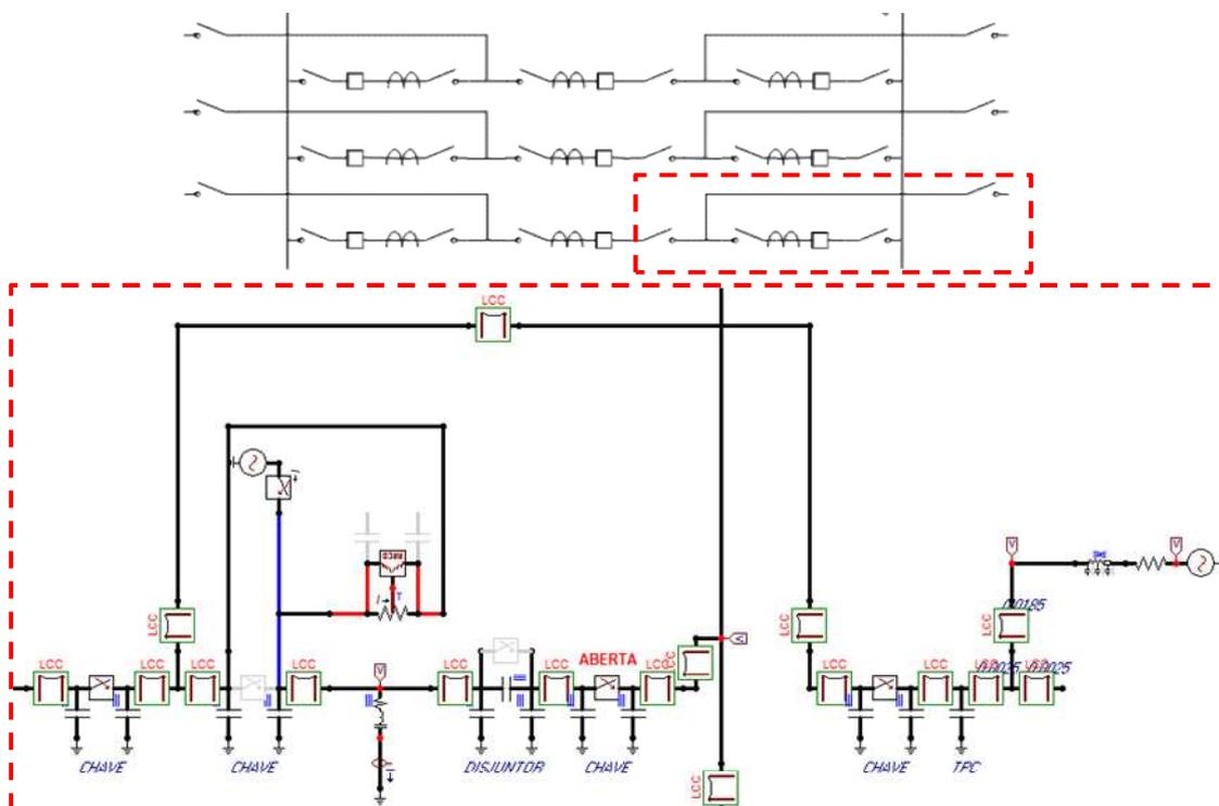
Figura 4.28 – Circuito utilizado para simulação *ATP-Draw/ATP*
