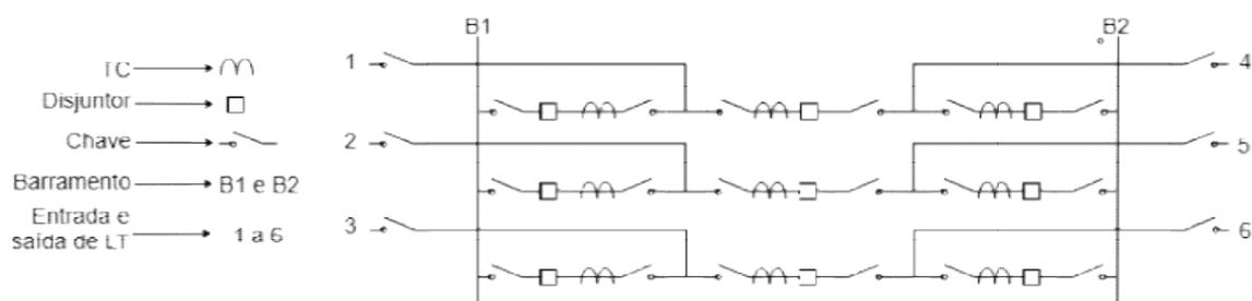
Figura 4.1 - Configuração em barra dupla com disjuntor e meio <sup>[20]</sup>
