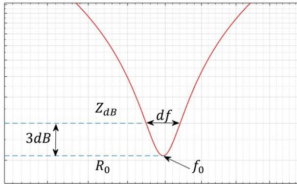
Figura 3.6 – Demonstração do método de cálculo do circuito RLC <sup>[19]</sup>
