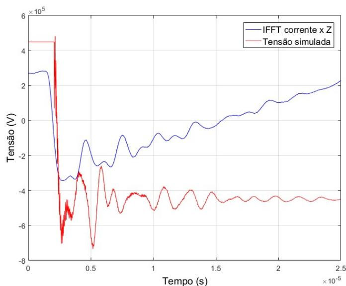
*Figura 4.31 – Sinal de tensão calculado e simulado*
