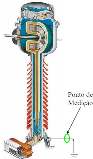
Figura 3.11 – Instalação do HFCT no TC
