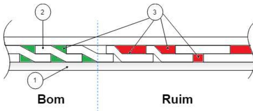
*Figura 2.3 - Exemplo de aplicação de fitas de papel impregnado com óleo no isolamento interno – condição ideal (verde) – condição irregular (vermelho)
