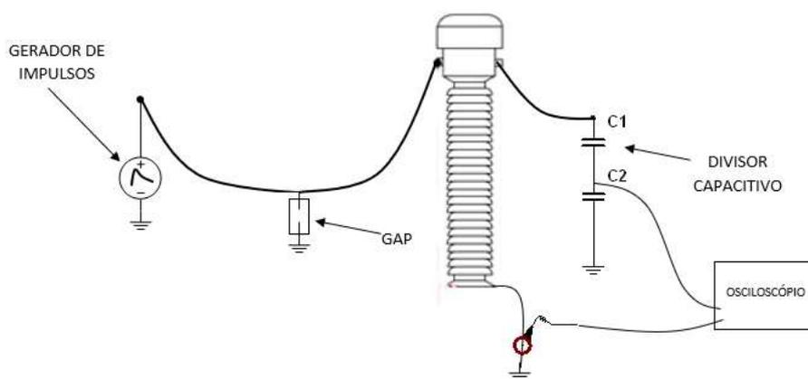
Figura 3.4 - Arranjo para caracterização utilizando o método impulsivo<sup>[18]</sup>
