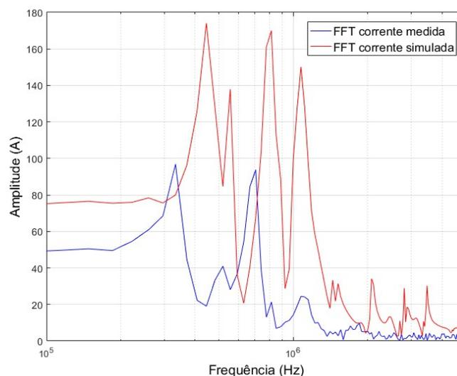
*Figura 4.30 – Corrente medido e simulado no domínio da frequência*
