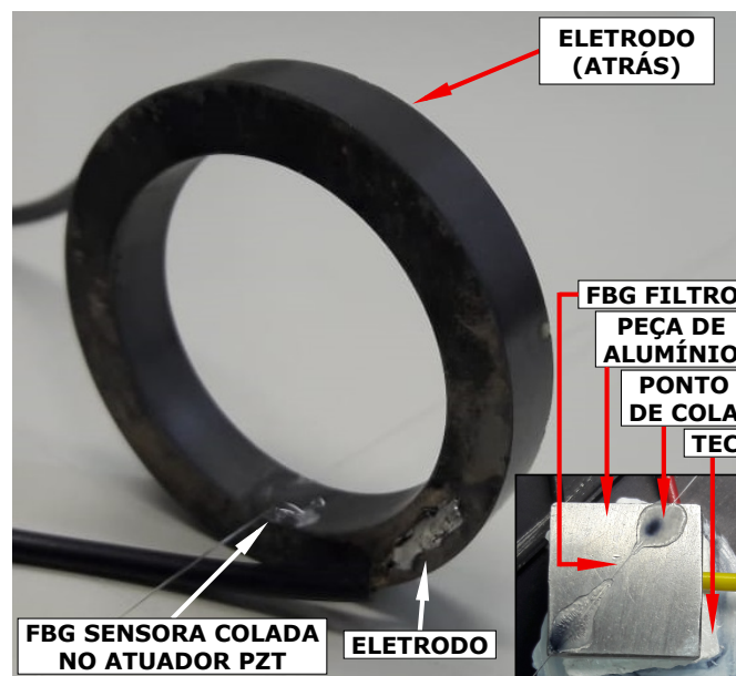
Figura 3.2: FBG sensora colada no diâmetro interior de uma cerâmica PZT em forma de anel. Inset: FBG filtro colada na superfície de um substrato de alumínio.
