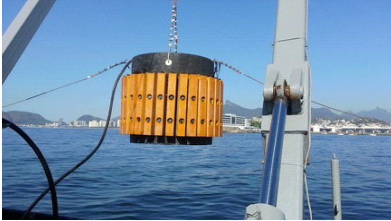
Figura 2.2: Exemplo de arranjo volumétrico: o arranjo cilíndrico de hidrofones, ou Cylindrical Hydrophone Array - CHA (imagem extraída de [6]).
