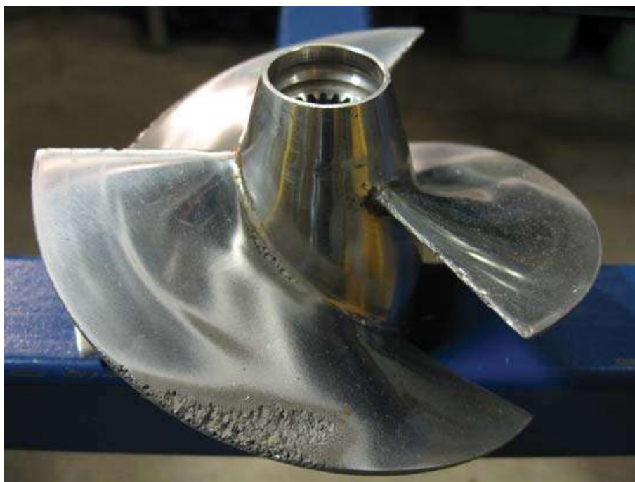
Figura 1.2: Efeito da Cavitação em uma Turbina ( https://www.britannica.com/science/cavitation ).
