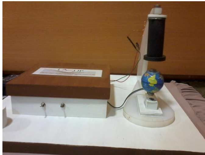
Figura 3.1. Sistema de Levitação Eletromagnética como protótipo funcional.
