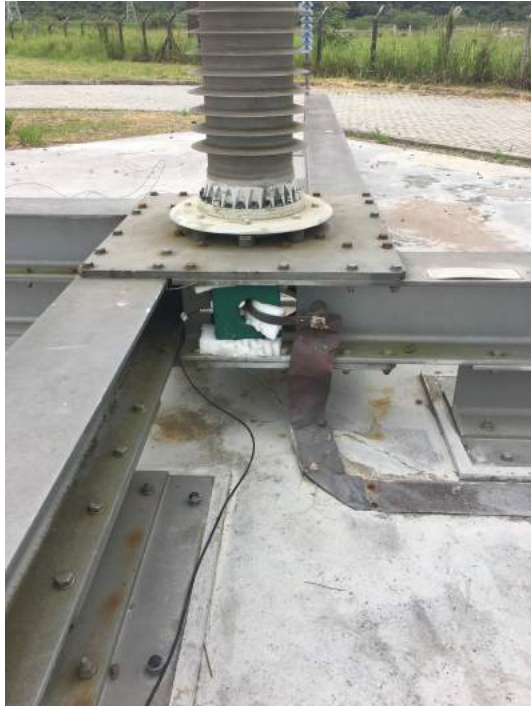
Medição de corrente no divisor
