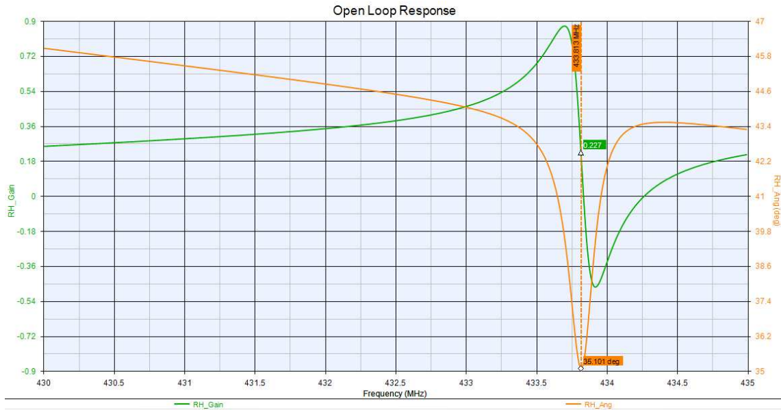
Figura 3.9: Gráfico de ganho em malha aberta do circuito Colpitts de base comum em relação à frequência com resistência equivalente série (ESR) de 900Ω.
