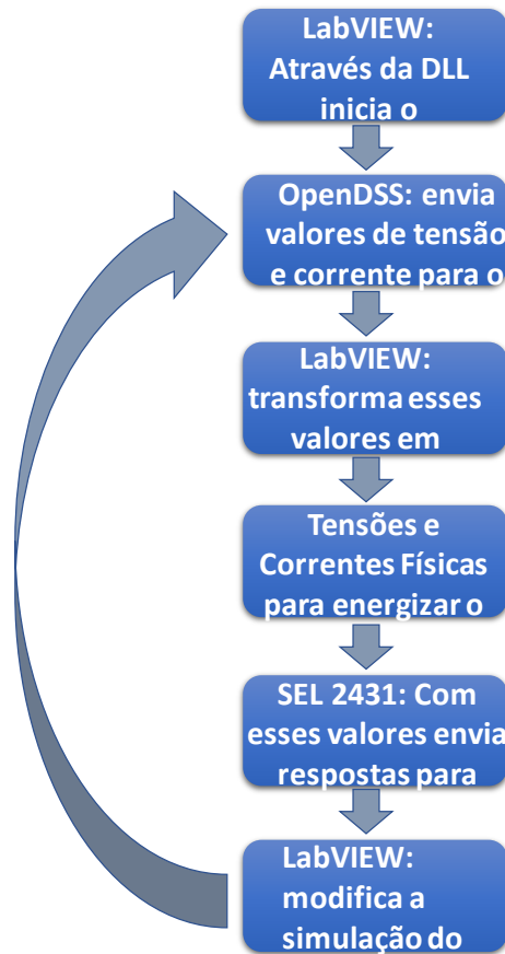
Figura 23: Sequência de ações do hardware in the loop.
