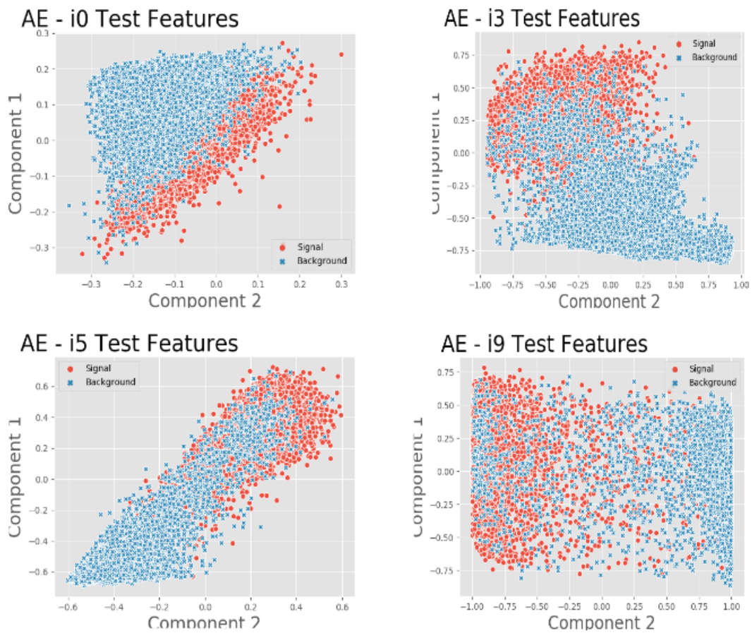
Figura 7.26: Projeção da informação anelada de calorimetria em duas componentes, obtidas através da rede auto-codificadora discriminativa com três camadas (50-25-2), para diferentes iterações.
