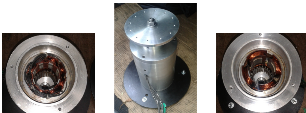
Figura 4.1: Protótipos de estatores: (a) à esquerda, estator com oito polos; (b) no centro, kit completo; (c) à direita, estator com quatro polos [31]
