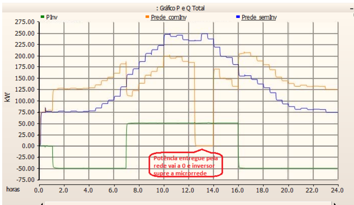
Figura 4.19: Potência Ativa da Rede com e sem a influência do Inversor Inteligente
