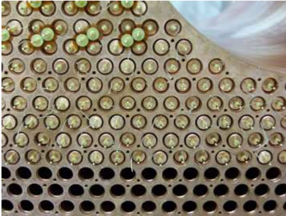
Figura 3.7: Ilustração da frente do módulo FCal1 durante a sua construção. Extraído de [33]
