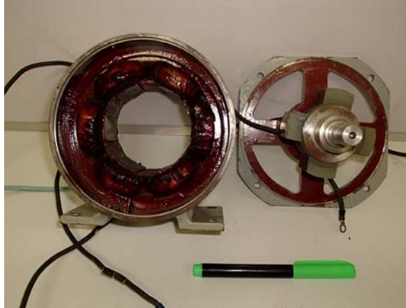
Figura 3 – Fotografia da máquina de relutância variável: rotor e estator
