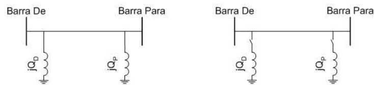
Figura 57 – Modelos de shunt de linha original (esquerda) e modificado (direita)
