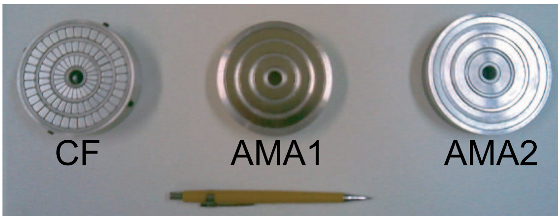
Figura 3.21: Foto com os rotores magnéticos dos mancais supercondutores para as configurações: CF e duas topologias de AMA.
