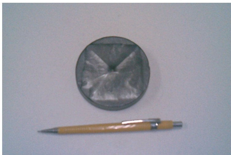
Figura 5.4: Amostra C75 de YBCO adquirida, com 75mm de diâmetro e 16mm de altura.
