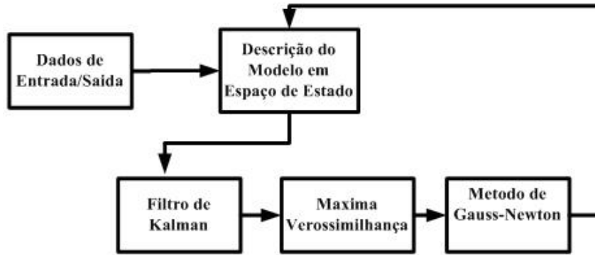
Figura 2.4: Diagrama geral da rotina de Estimação dual
