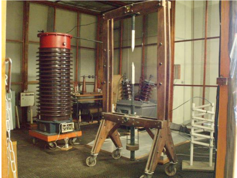
Figura 4.15: Circuito implementado para representar o arco no ar
