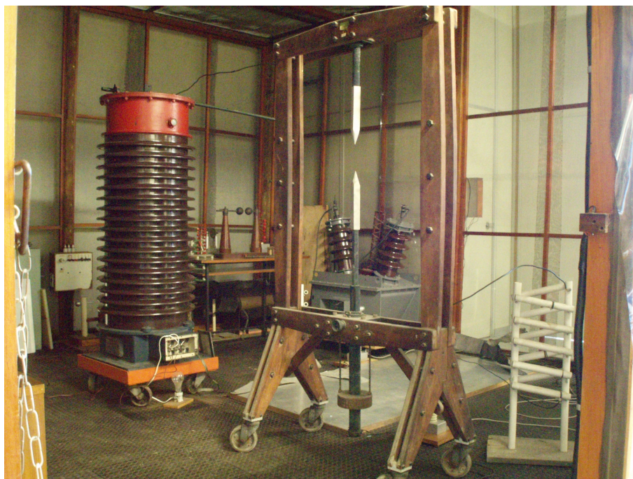
Figura 4.40: Circuito implementado para representar o arco no ar
