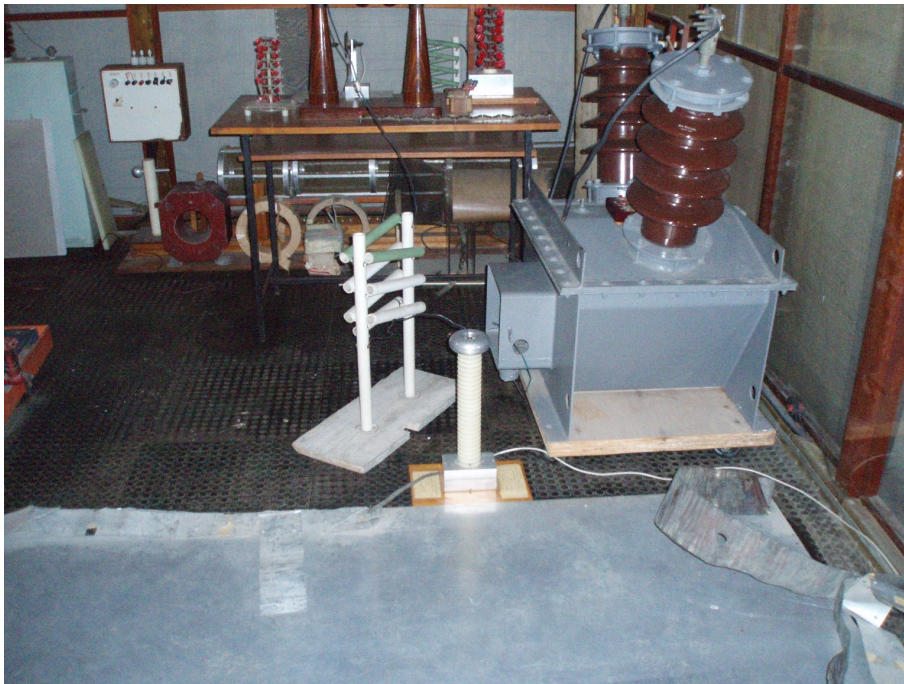
Figura 4.41: Circuito implementado para representar o arco no ar
