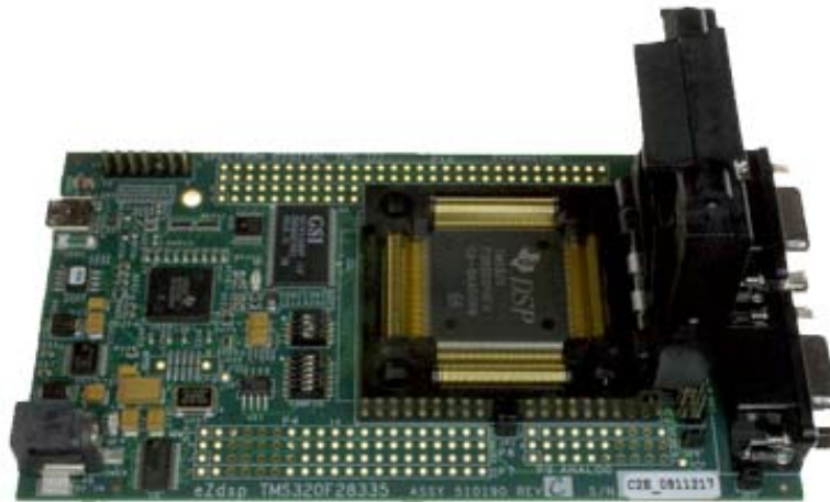
Figura 82: DSP da TEXAS modelo TMF320F28335.
