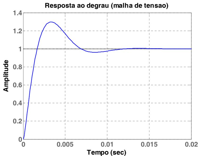
Figura A.4: Resposta ao degrau da malha fechada de tensão
