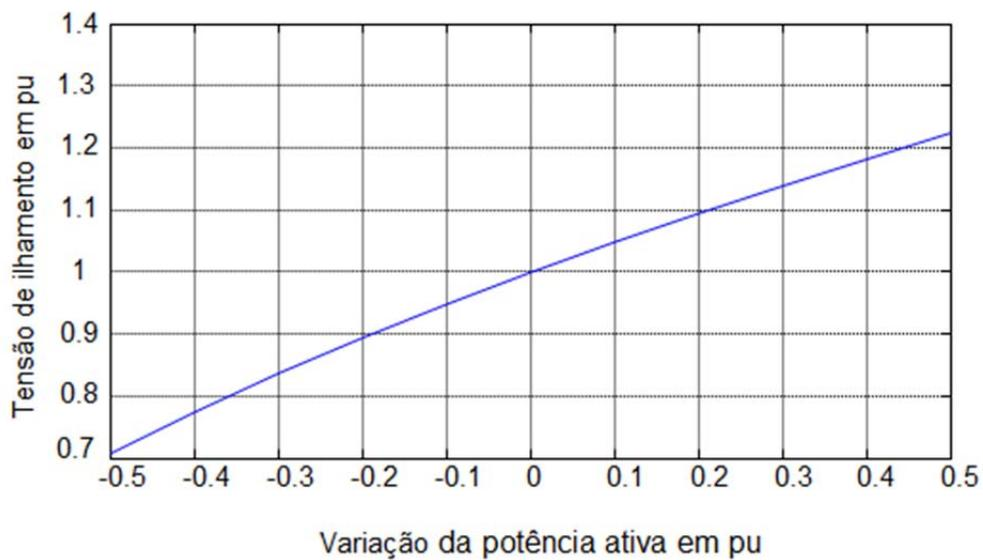
Figura 4.12: Variação da tensão de ilhamento em função de  $\Delta P$
