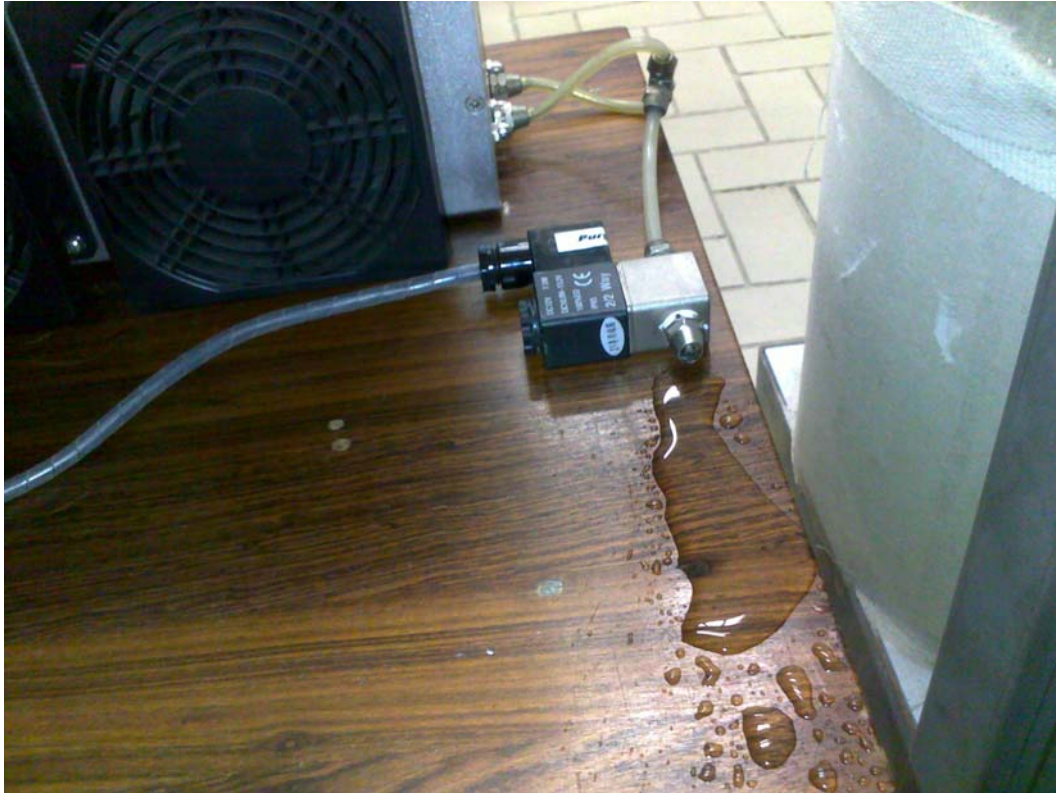
Figura 3-32 – Excesso de água na saída da válvula de purga de hidrogênio ao final do experimento.
