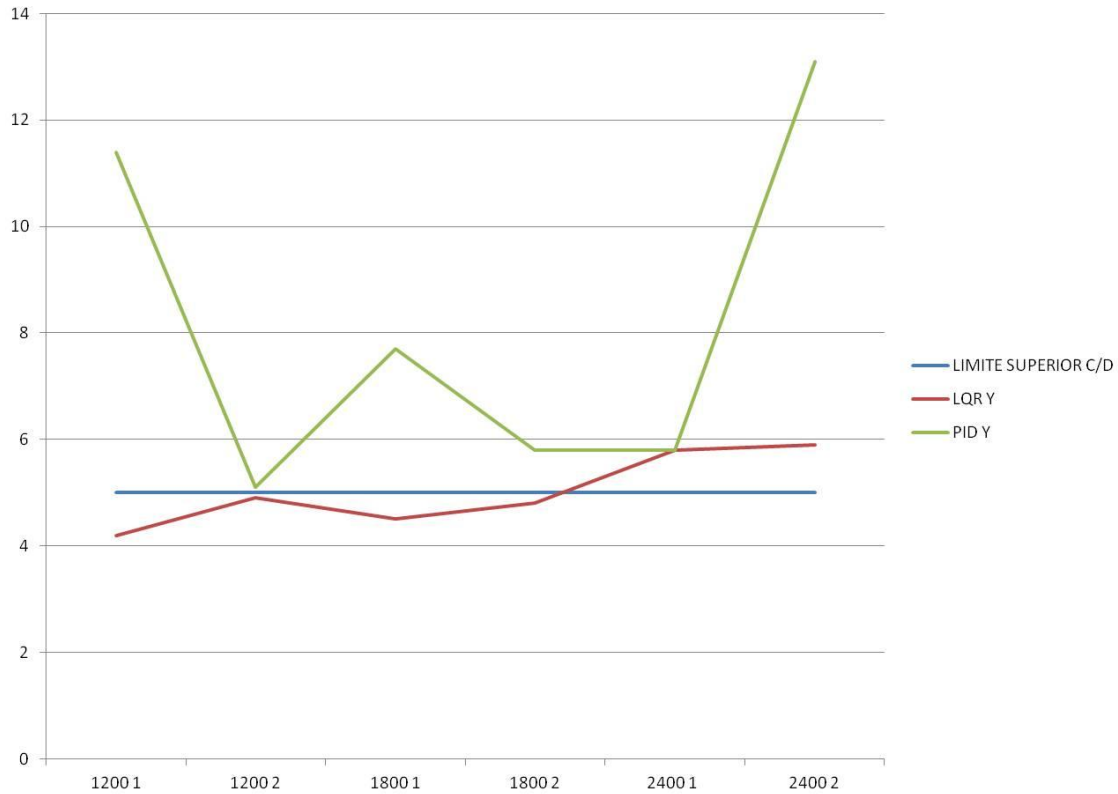
Figura 6-28 Picos da função sensibilidade para dados experimentais obtidos para eixo Y
