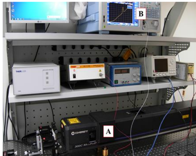
Figura 7.26: Esquema para produção de redes de Bragg por interferência de feixes de lasers ultravioleta no Laboratório de Instrumentação e Fotônica (COPPE/UFRJ); A – Laser ultravioleta de potência para inscrição da FBG em fibra óptica; B – OSA para monitoramento do comprimento de onda de Bragg
