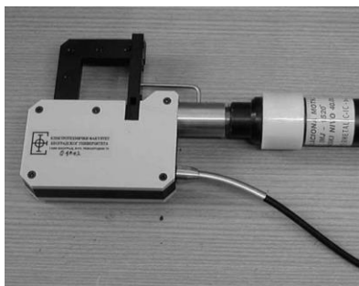
Figura 2.4: Sensor de corrente a fibra óptica portátil (adaptado de PETRICEVIC et al. [13])
