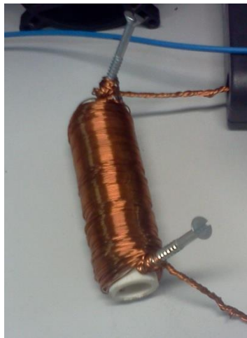
Figura 4.13: Bobina de excitação construída, de acordo com o procedimento descrito por ENGDahl et al. [45]
