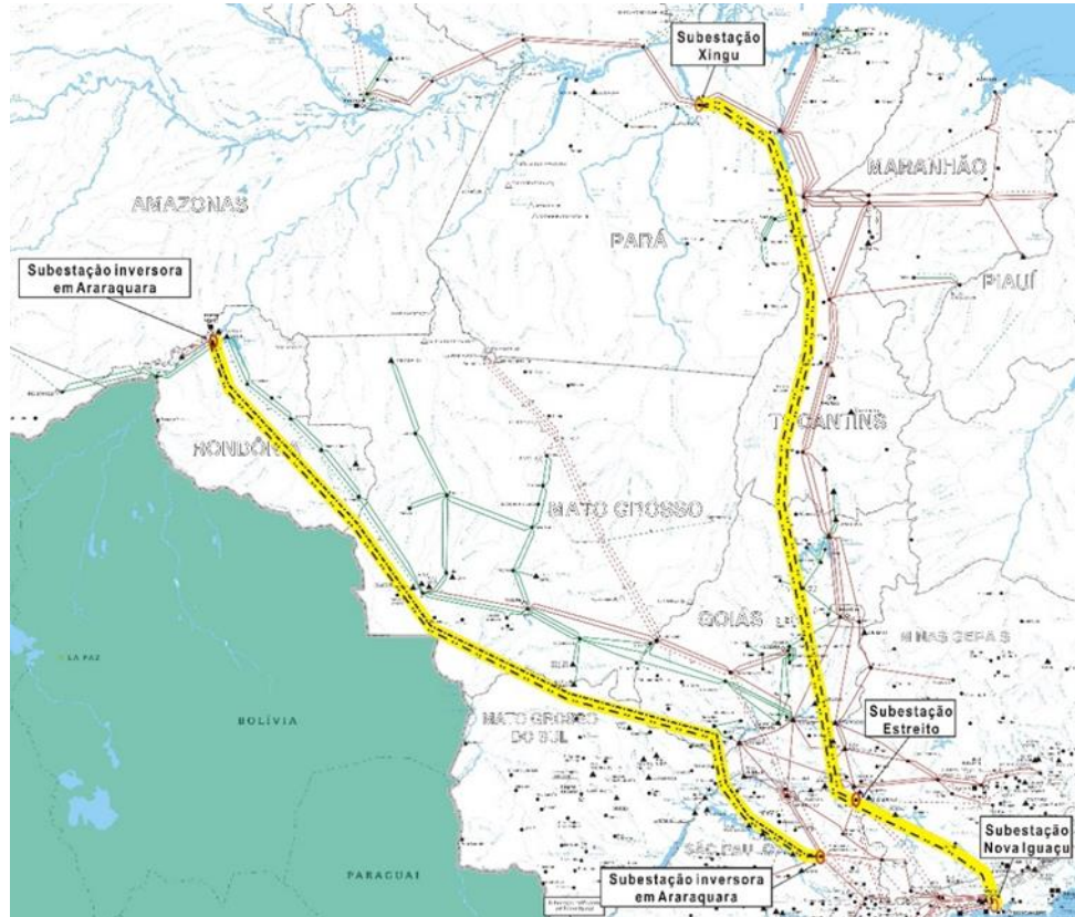
Figura 3- Traçado dos sistemas de transmissão CCAT das usinas do Rio Madeira e da expansão da interligação Norte-Sul com Belo Monte. (Fonte: Eletrobras)
