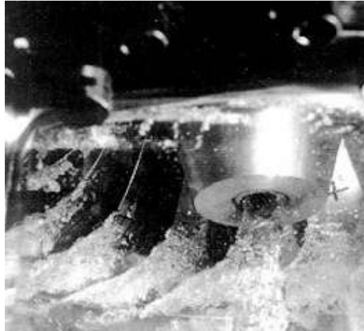
Figura 18 - Cavitação em bolhas itinerantes no bordo de fuga das lâminas do rotor.
