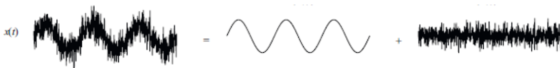
Figura 14 - Decomposição de um sinal cicloestacionário de primeira ordem (à esquerda) em suas componentes determinística (no centro) e aleatória (à direita).
