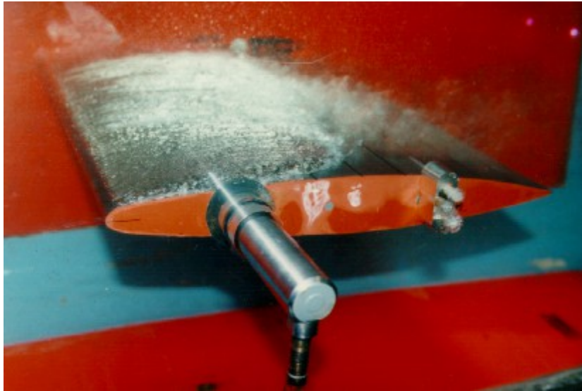
Figura 20 - Cavidade fixa no bordo de ataque de um hidrofólio em túnel de testes e formação da cavitação em nuvem. O escoamento é da esquerda para a direita.
