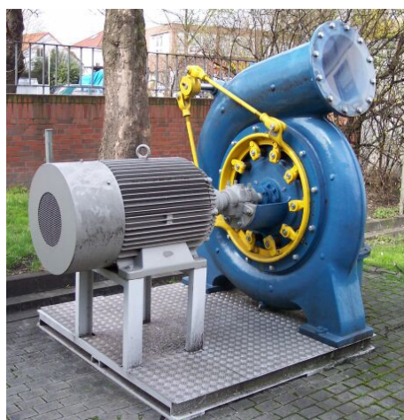
Figura 7 - Turbina tipo Francis conectada a um gerador. Notar a caixa voluta em azul e o regulador de potência em amarelo.
