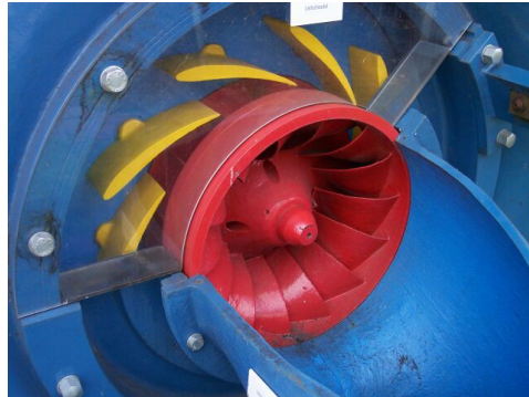
Figura 8 - Corte de uma turbina Francis mostrando as palhetas do distribuidor em amarelo e o rotor em vermelho.
