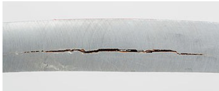
Figura 2 - Trinca no aço induzida por hidrogênio.
