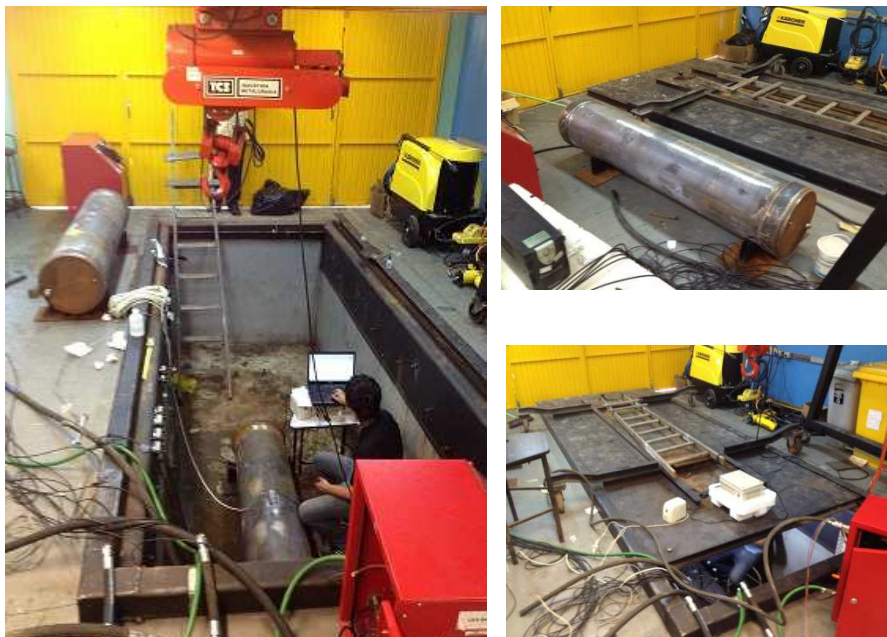
Figura 54 – Preparativos do corpo de ensaio no bunker para realização do ensaio hidrostático.
