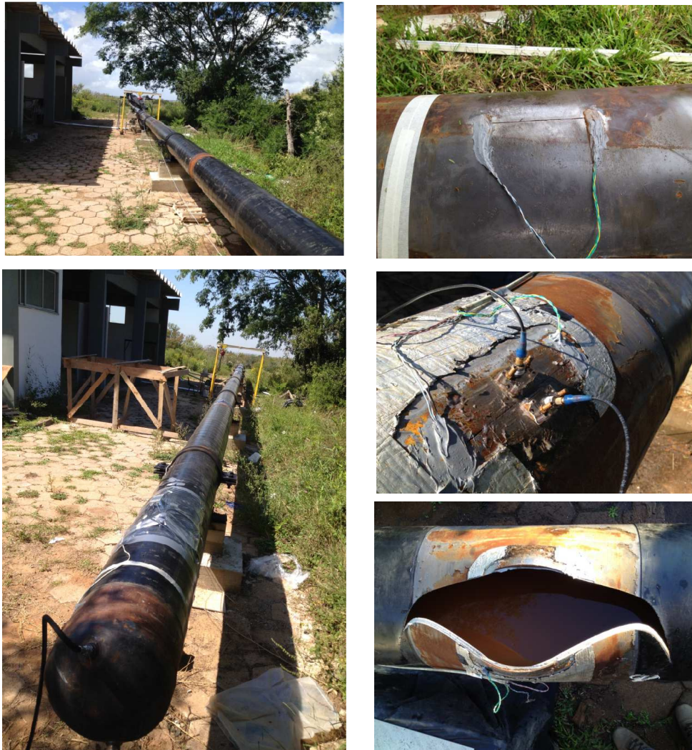
Figura 95 – Ensaio hidrostático experimental para dutos longos (coluna esquerda: visão do corpo de provas de 40 metros – coluna direita: trinca, trinca e ToFD e trinca após o ruptura:
