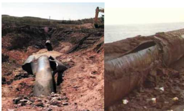
Figura 2 – Visualização dos danos causados por falhas catastróficas em gasodutos [37].
