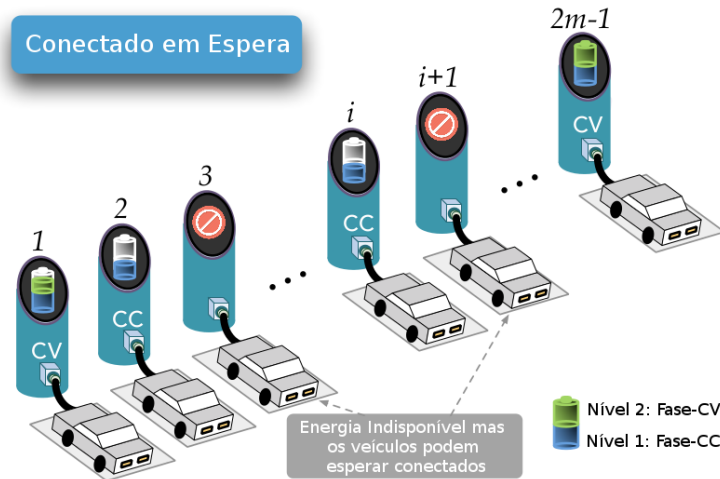
Figura 5.19: Cenário Conectado em Espera – O ESCVE que se encontra com símbolo de proibido pode ser usado pelo veículo como vaga de espera.
