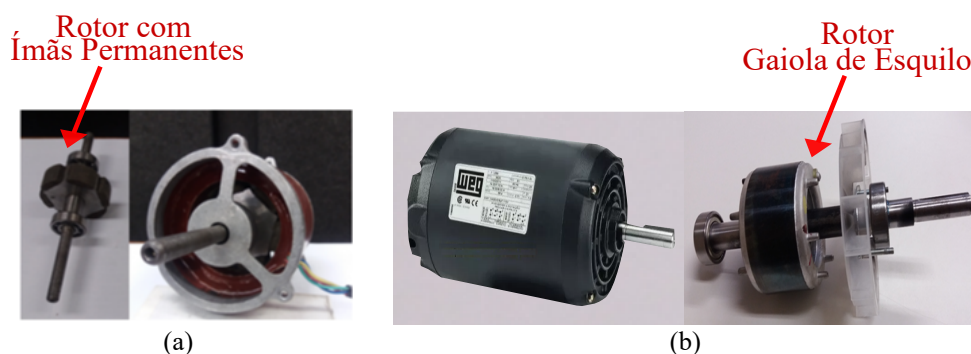
Figura 3.1: (a) Máquina síncrona trifásica com ímãs permanentes e (b) Máquina de indução trifásica de rotor gaiola.
