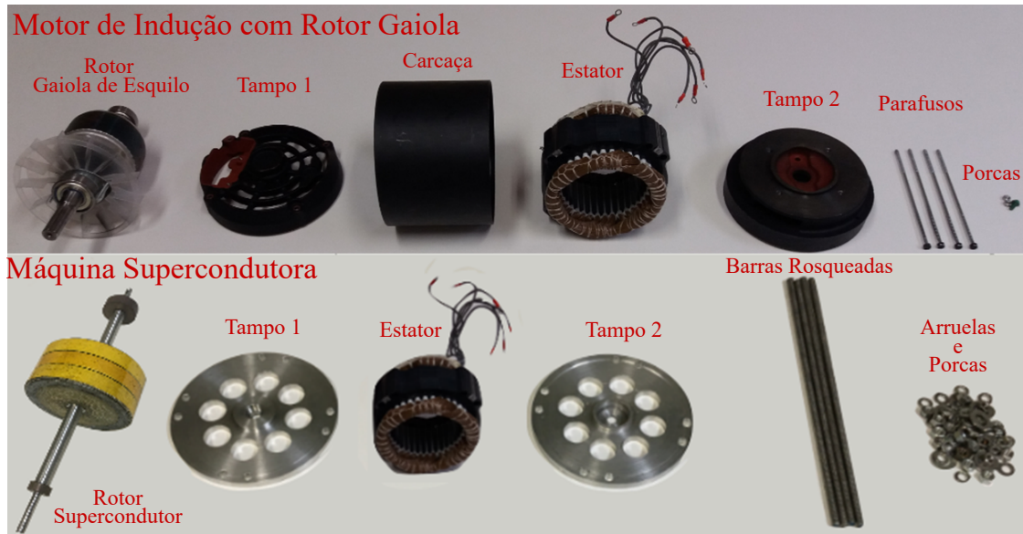
Figura 3.9: Comparação do motor de indução gaiola com a máquina supercondutora.
