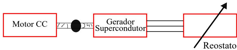
Figura 5.17: Ilustração da alteração de carga pela variação da impedância do reostato trifásico.
