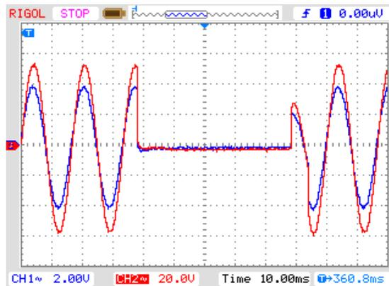
Figura 6.25 – Tensão de entrada (CH1) e tensão de saída do amplificador (CH2) durante interrupção de tensão.
