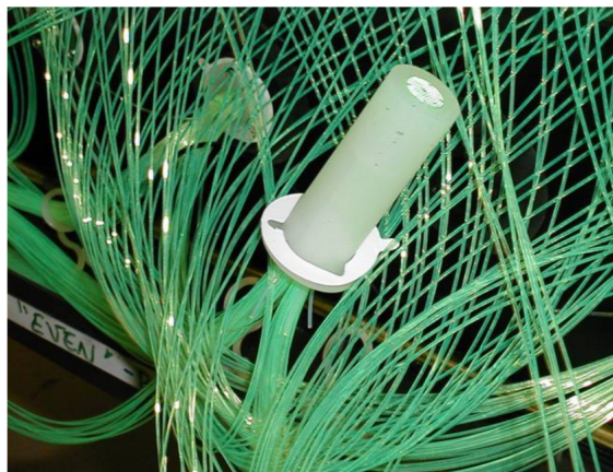
Figura 3.5: Aglomerado de fibras acoplado ao seu misturador de luz. Extraído de [58].
