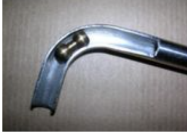
Figura 6.2: Capsula de Césio, usada durante a calibração, dentro de um dos tubos por onde ela navega.
