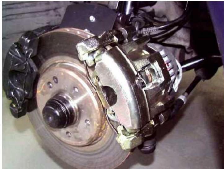
Figura 2.9: Foto de um freio eletromecânico montado em um veículo
