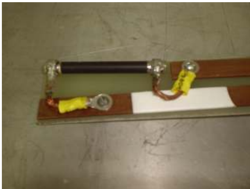
Figura D.2. Fixação do tubo supercondutor no dispositivo apresentado na Figura D.1.
