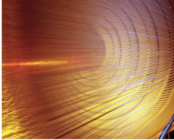
Figura 3.2: Detector CDF: Visão interna do Central Outer Tracker
