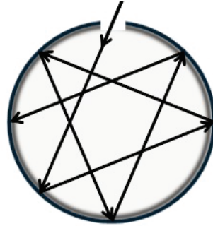
Figura 3.3: Aproximação do corpo negro por uma cavidade.
