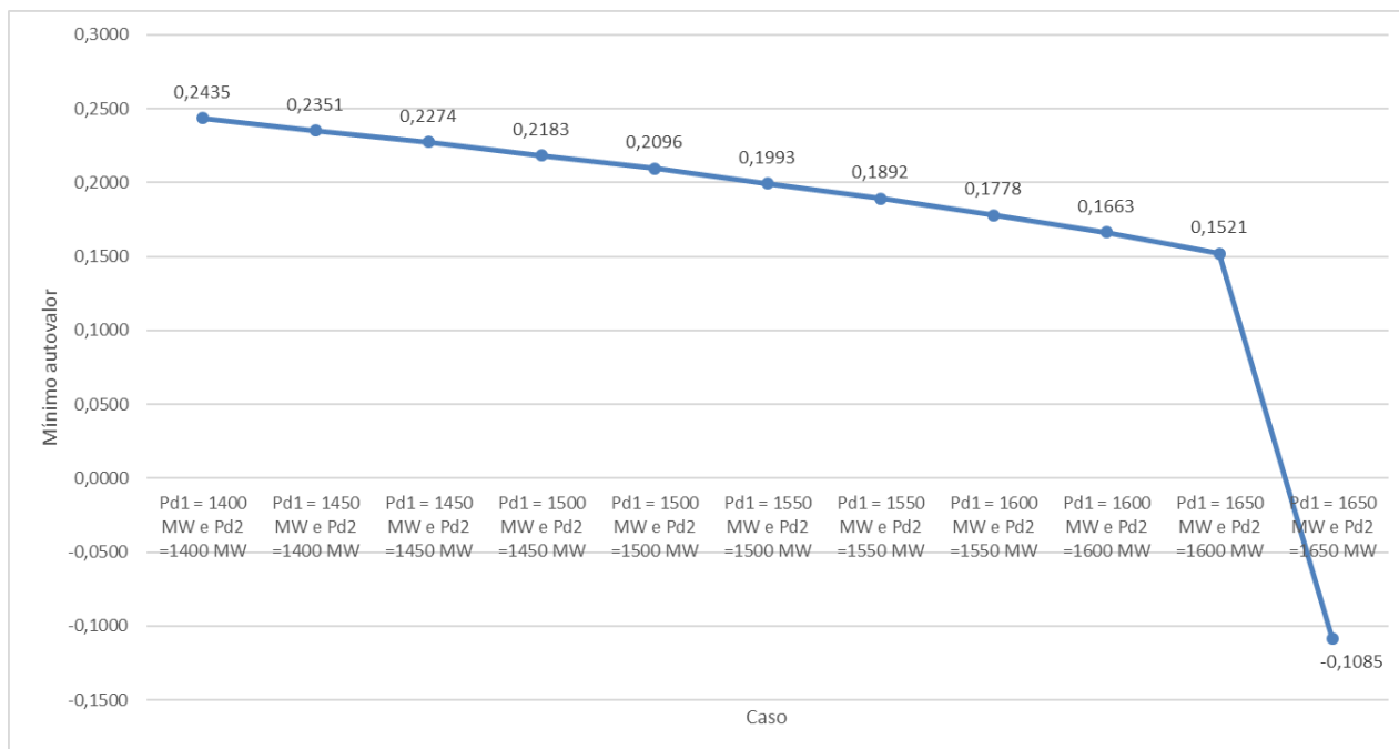
Figura 32: Comportamento do modo crítico do sistema-teste à medida que se eleva a potência injetada nos elos CC
