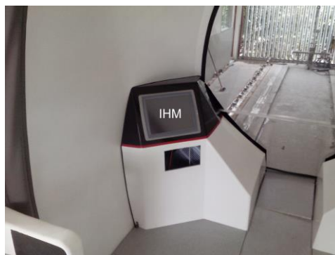
Figura 6.2 – Interface Homem Máquina (IHM) que faz parte do sistema supervisório interno do MagLev-Cobra.
