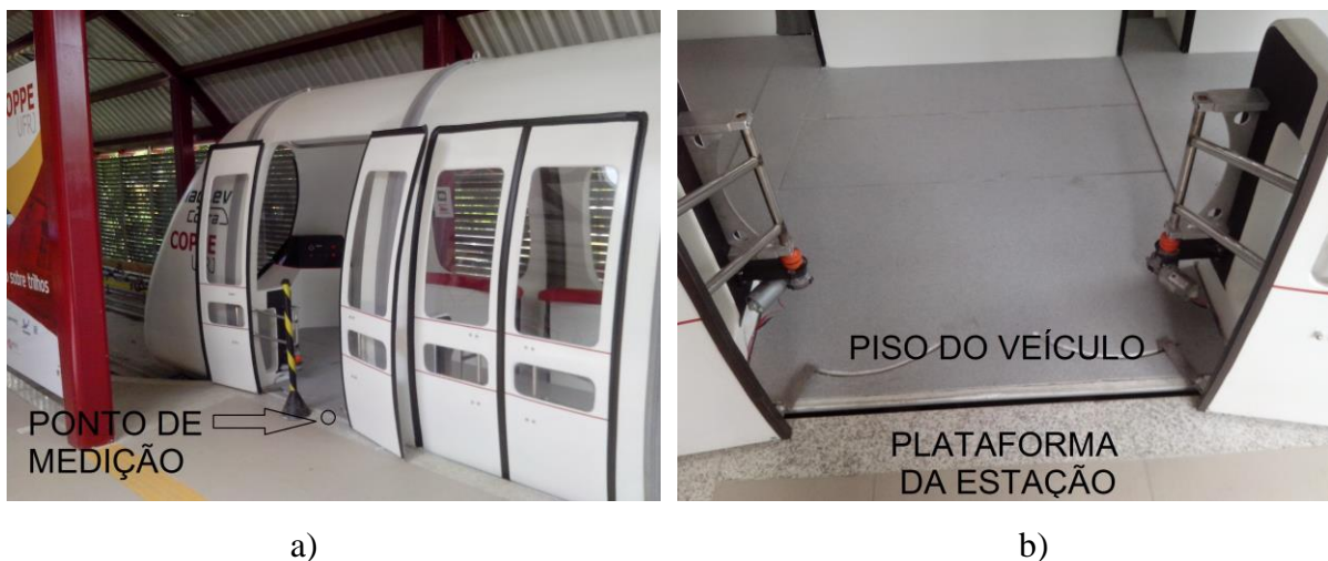
Figura 6.4 – Medição das folgas entre o MagLev-Cobra e a estação. a) ponto de medição com o veículo parado, travado e com as portas abertas; b) ampliação do ponto de medição.
