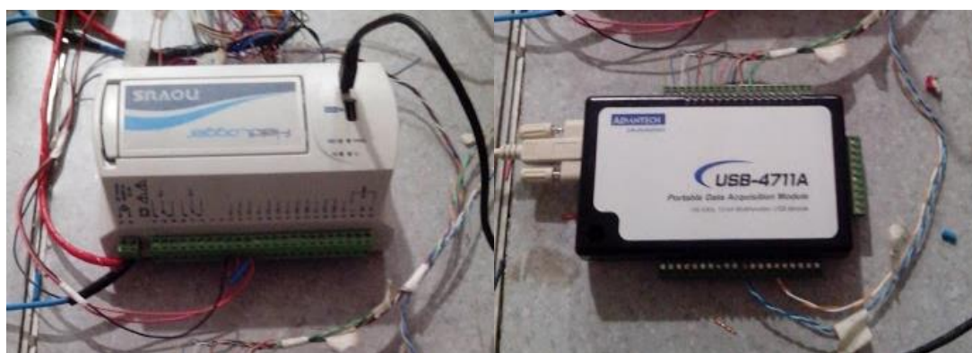
Figura 5.27 – Sistemas de aquisição de dados de levitação e velocidade, FieldLogger NOVUS e placa Advantec USB-4711A.
