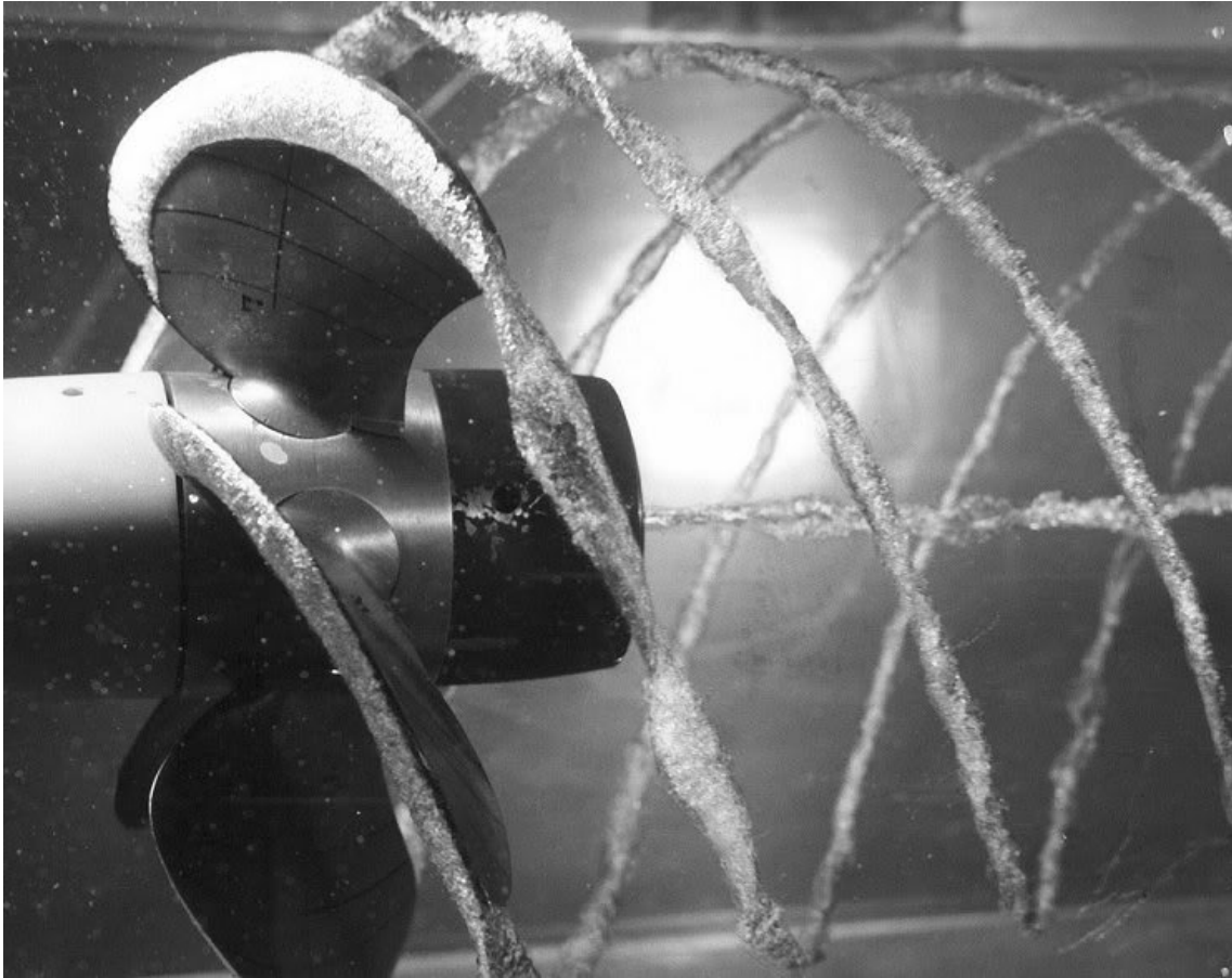
Figura 2.1: Bolhas sendo formadas pelo processo de cavitação, figura extraída de [40]
