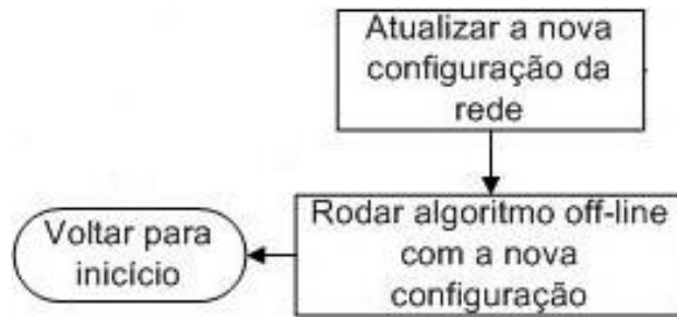
Figura 35 - Oitavo passo do algoritmo de identificação de falha on-line
