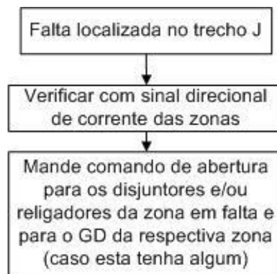
Figura 27 - Quarto passo do algoritmo de identificação de falha on-line
