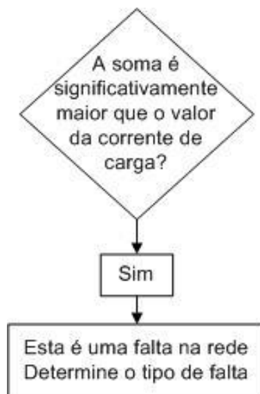
Figura 23 - Segundo passo do algoritmo de identificação de falha on-line
